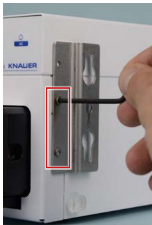
Fig. 31 UVD 2.1S & mount. bracket
