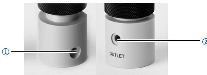
**Abb. 7:** Inlet und Outlet der pH-Elektrode
