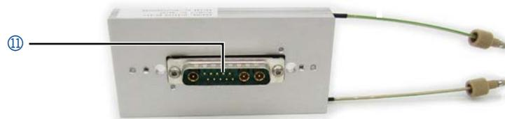
**Abb. 5:** CM-Flusszelle: Rückseite mit Stecker
