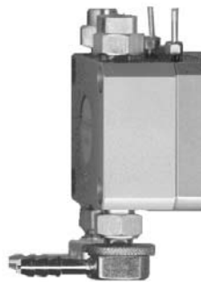
Abb. 6 Pumpenkopf: Anschluss von Lösungsmitteln 1000 ml Kopf
