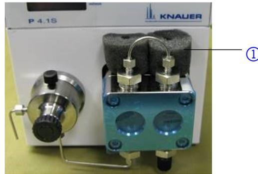
**Abb.5** Transportschutz zwischen Enden der Pumpenkapillaren und Gehäuse
