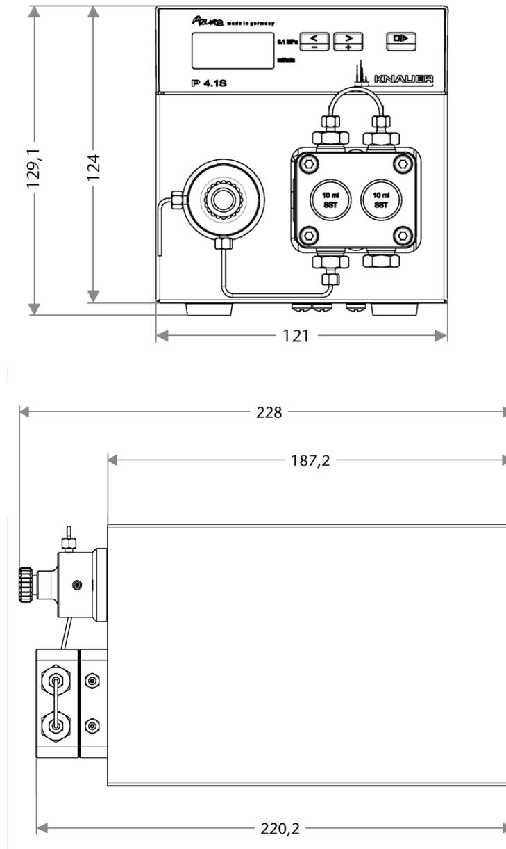
**Abb. 28** Abmaße der Pumpe in mm
