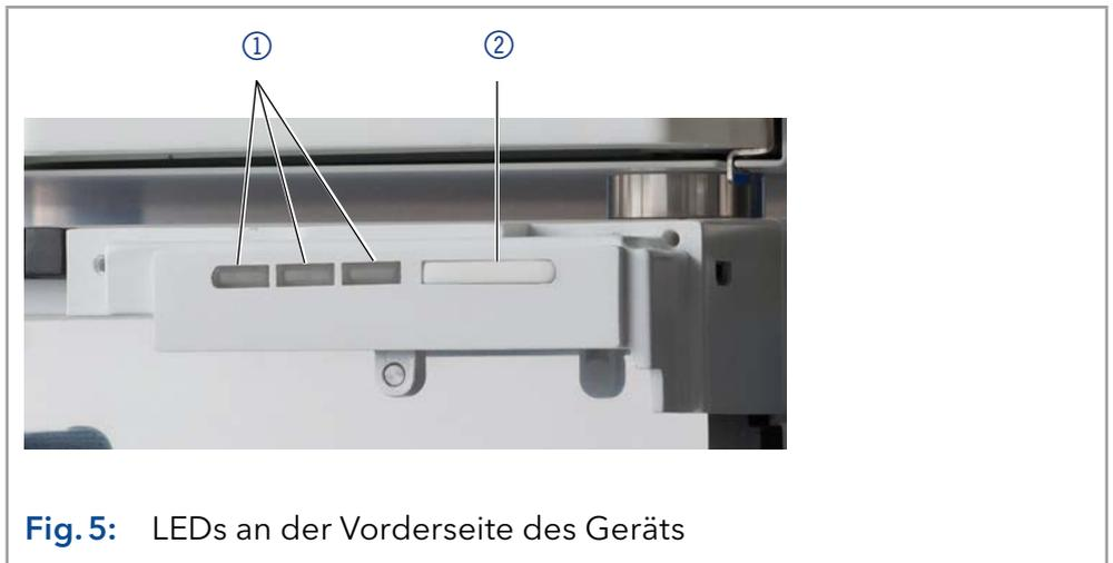
**Fig. 5:** LEDs an der Vorderseite des Geräts
